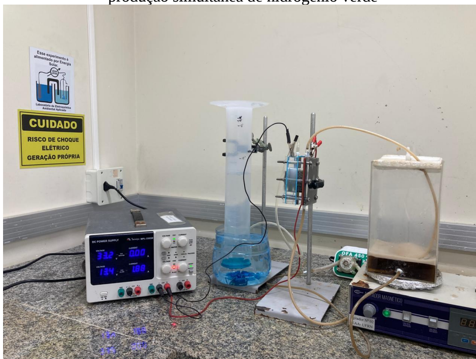
Figura 18 - Configuração experimental do processo de tratamento eletroquímico com produção simultânea de hidrogênio verde
