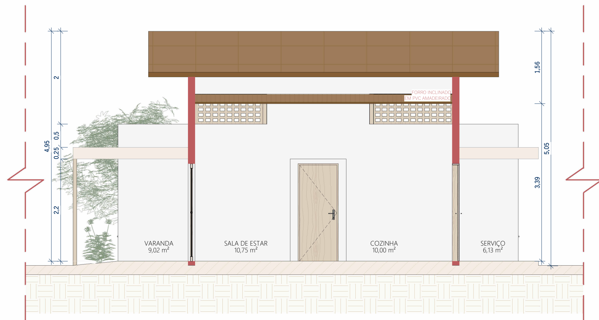
27 CORTE AA - RESIDÊNCIA 2 QUARTOS ESC. 1:50
