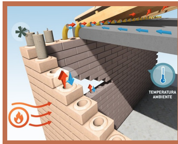
Figura 29: Troca de calor pelos furos.
