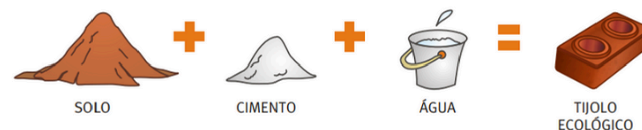
Figura 34: Composição tijolo solo-cimento. Fonte: Cartilha Eco produção, 2022.
