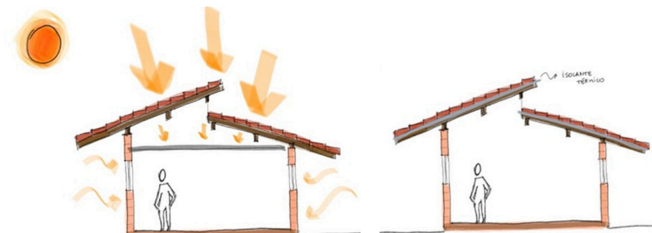
Figura 17: Coberturas isoladas para diminuir a transmitância térmica.
