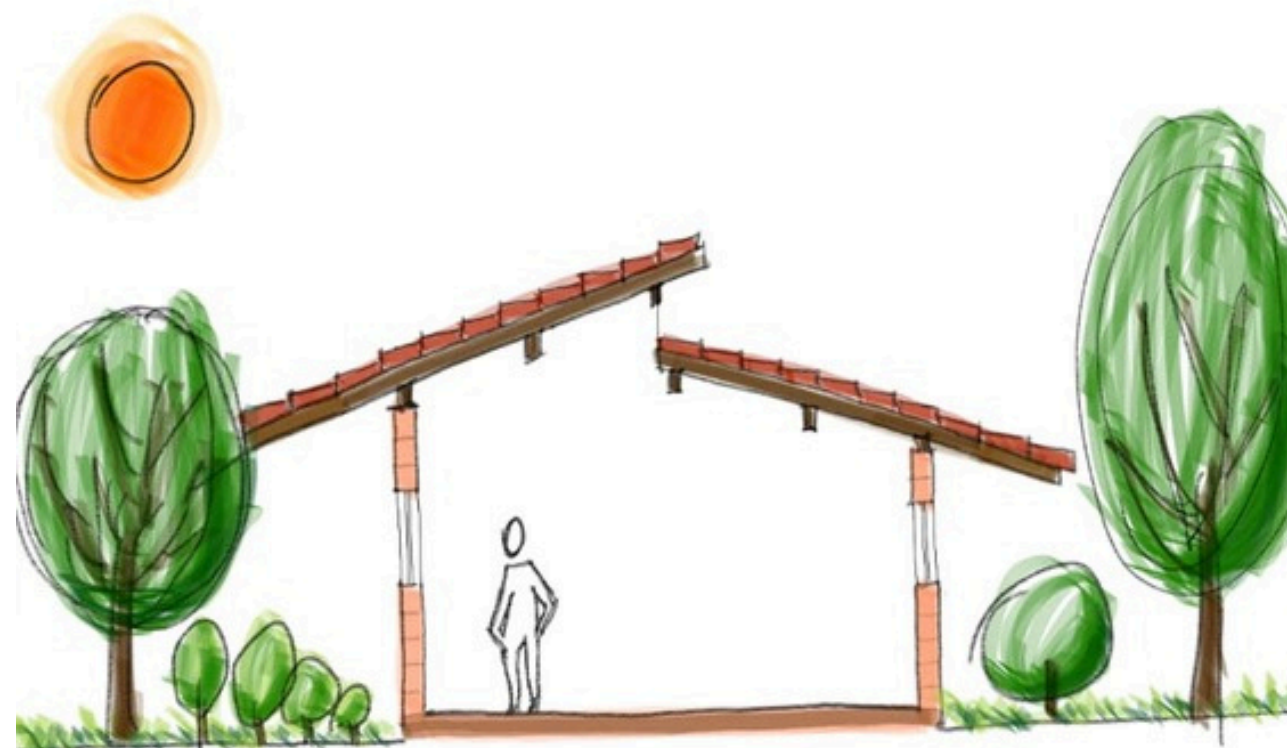
Figura 15: Sombreamento por meio de beirais e vegetação.
