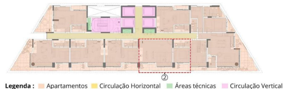
Figura 13: Setorização Pavimento tipo Stúdios
