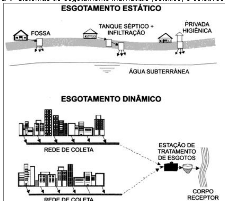
Figura 4- Sistemas de esgotamento individuais (estático) e coletivos (dinâmico)
