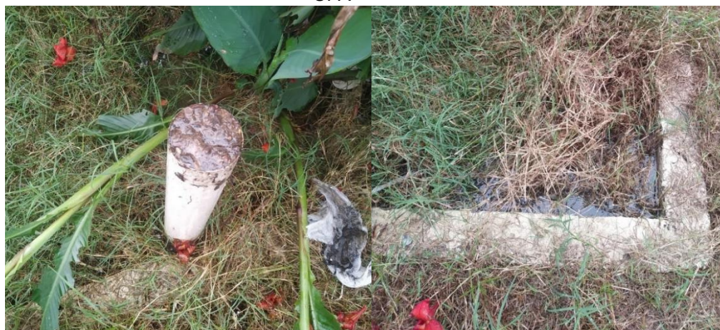
Figura 39. Transbordo do esgoto pelo cano exaustor e solo encharcado no protótipo UPA
