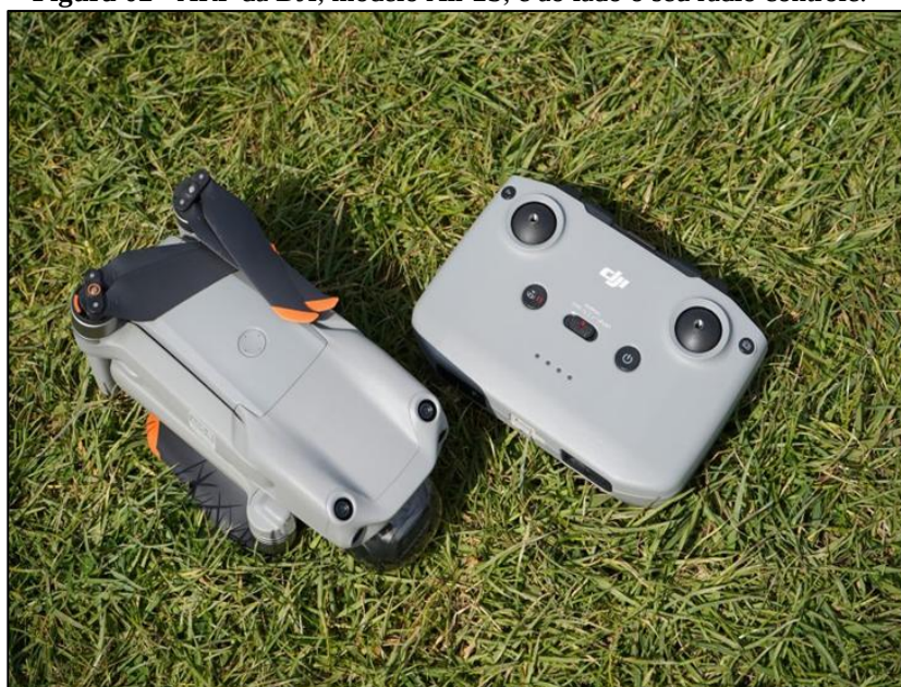
Figura 02 - ARP da DJI, modelo Air 2S, e ao lado o seu rádio controle.
