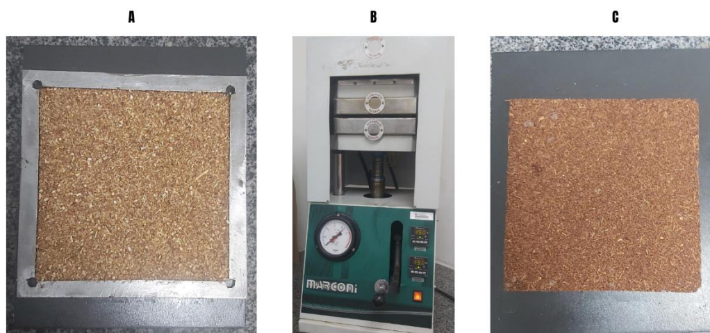
A) Preenchimento do molde; B) Prensagem; C) Placa finalizada. Fonte: Autora, 2024.
