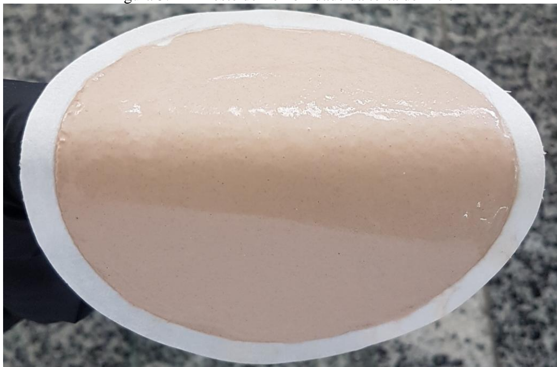
Figura 5.14 – Teste de flexibilidade da torta de filtro
