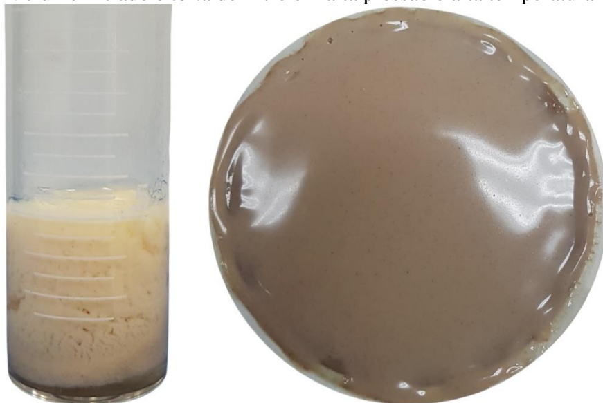
Figura 5.38 – Volume filtrado e torta de filtro em alta pressão e alta temperatura do fluido F2
