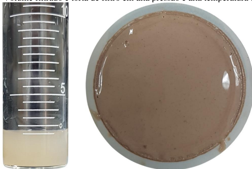
Figura 5.50 – Volume filtrado e torta de filtro em alta pressão e alta temperatura do fluido F4
