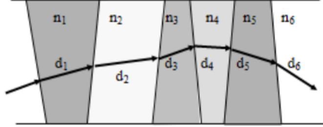
Figura 15 – A luz passa por diferentes camadas de materiais, i.e diferentes índices de refração. Em cada interface pode-se aplicar a lei de Snell, obtendo-se a trajetória da luz.
