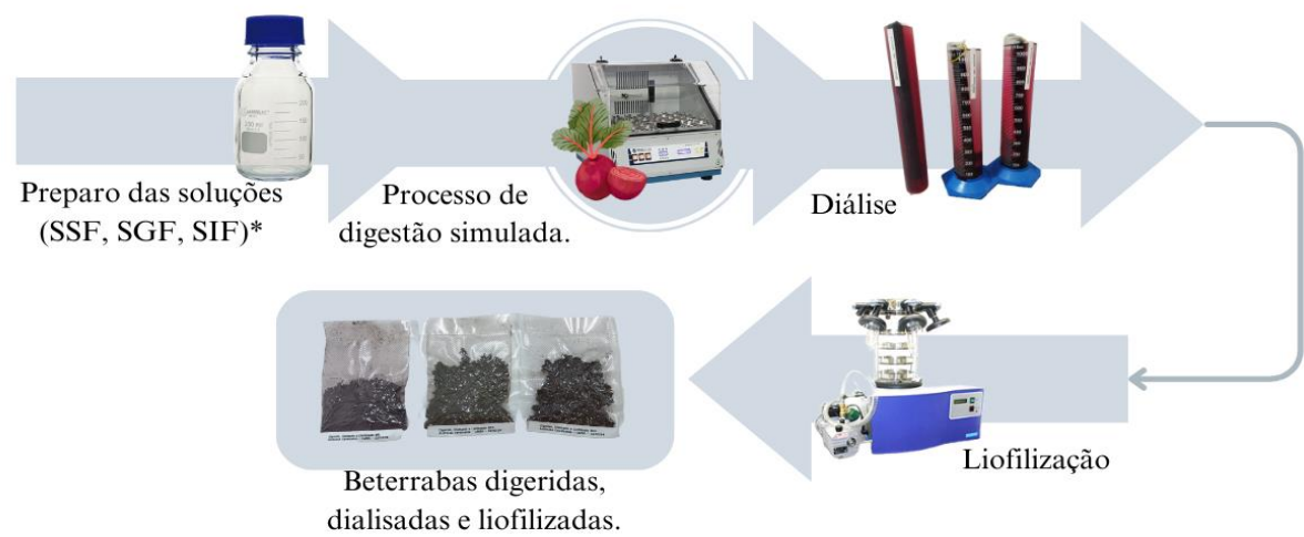
Figura 6 – Processo de digestão simulada in vitro .
