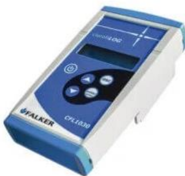
Figura 15 - Modelo de medidor de clorofila portátil tipo spad utilizado no bioensaio de fitotoxicidade crônica.
