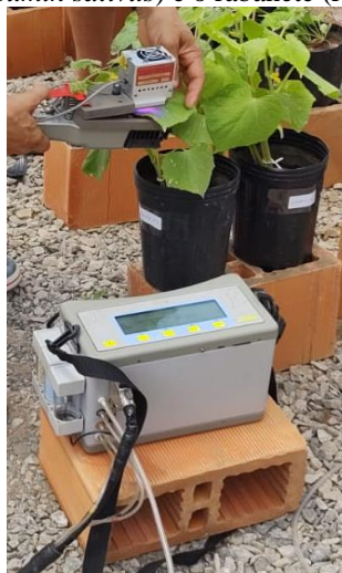
Figura 16 - Analisador de fotossíntese IRGA utilizado no bioensaio de fitotoxicidade crônica da cultura de pepino ( Cucumis sativus ) e o rabanete ( Raphanus sativus ).
