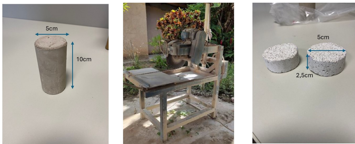
Figura 28- Seccionamento dos corpos de prova para análise microestrutural.
