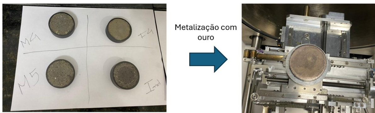
Figura 29- Imagem da das amostras preparadas com resina e após metalização da superfície com ouro.
