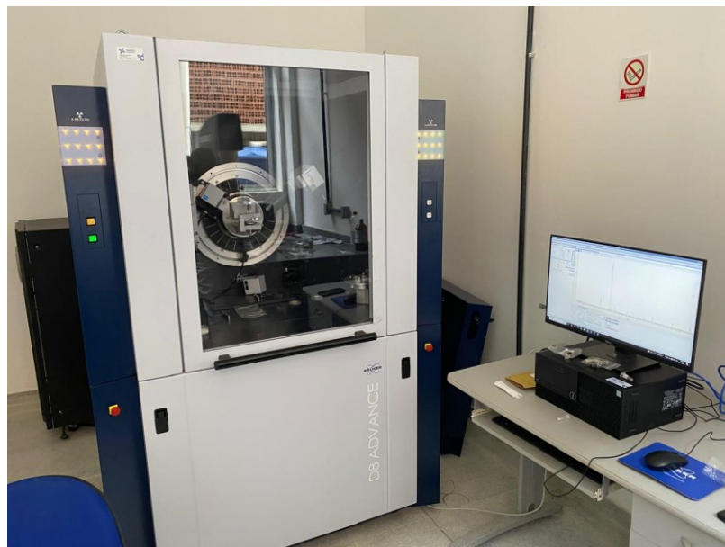
Figura 31- Equipamento da Marca Bruker modelo D8 Advance utilizado na análise de Difração de Raios-X.
