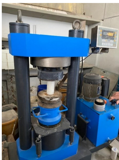
Figura 23- Corpo de prova na prensa vertical para ensaio de compressão axial.
