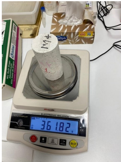
Figura 26- Determinação da massa do corpo de prova para determinação da densidade de massa.
