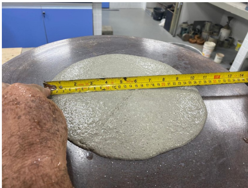
Figura 21- Medida de espalhamento da argamassa na mesa de consistência após aplicação dos golpes
