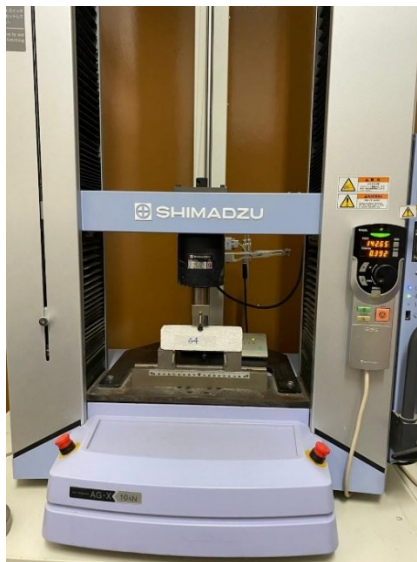
Figura 24- Equipamento utilizado para ensaio a tração por flexão.
