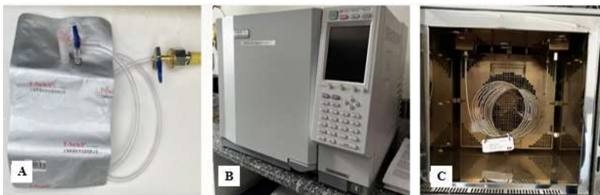
Figura 10. Análise cromatográfica do biogás. (A) Procedimento de coleta de biogás através da tubulação do biodigestor (Autor, 2024). (B) Vista externa do cromatógrafo TCD/FID (Autor, 2024). (C) Coluna de carbonex do cromatógrafo gasoso (Autor, 2024).
