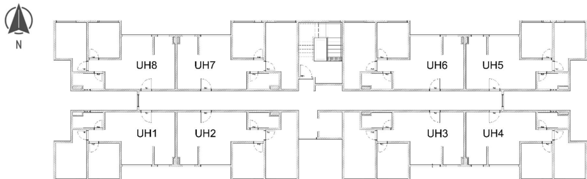
Figura 34 - Planta baixa do pavimento tipo da HIS multifamiliar simulada. Distribuição das UHs na lâmina.
