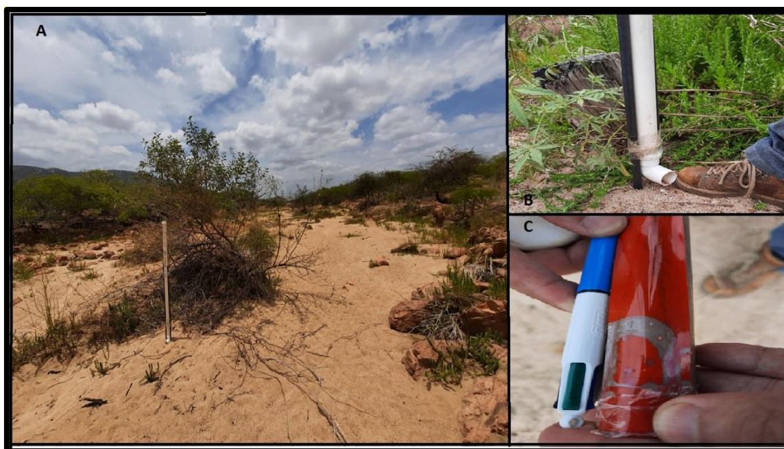
Figura 5 Equipamento crest. A: equipamento instalado em campo para coleta do nível da vazão. B: equipamento fixado por cantoneiras de ferro. C: fita adesiva sensível a água
