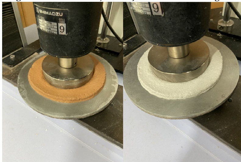
Figura 13: Ensaio de squeeze-flow nas argamassas após o deslocamento. a) Execução do ensaio nas argamassa com MC. b) Execução do ensaio nas argamassa com CC.
