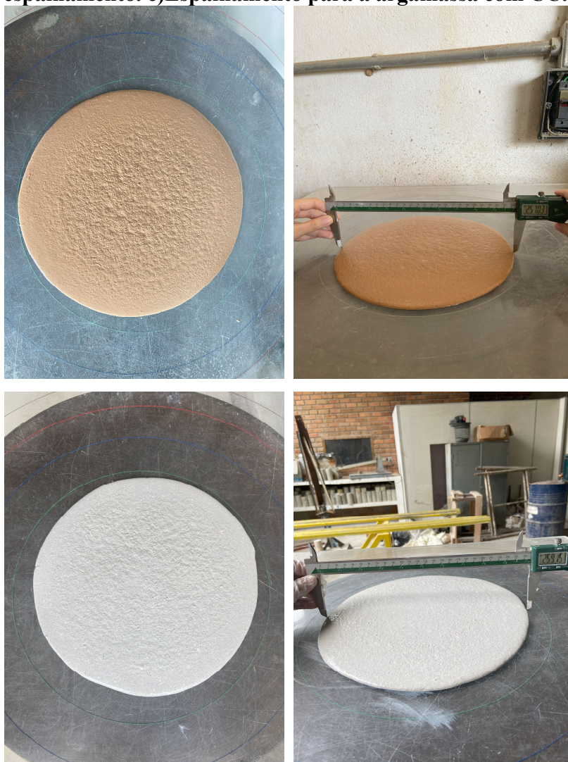
Figura 12: Ensaio da mesa de consistência para definição da relação água/aglomerante. a) Espalhamento para a argamassa com MC. b) e d) Medição do espalhamento. c) Espalhamento para a argamassa com CC.
