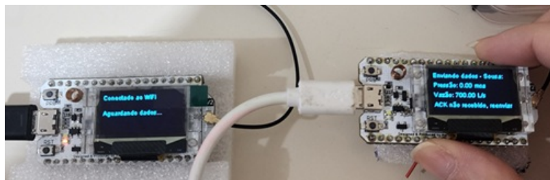
Figura 22 – Gateway , à esquerda, conectando ao Wi-Fi e Sender , à direita, aguardando-o para reenviar os pacotes.
