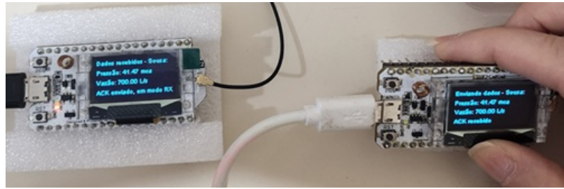
Figura 23 – Gateway recebe os pacotes de dados, envia o ACK de confirmação, garantindo que a transmissão foi bem sucedida
