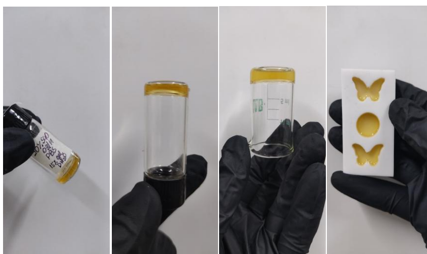
Figura 23 – Imagens do teste de inversão do tipo para determinação do tempo de gelificação e apresentação do hidrogel no molde.
