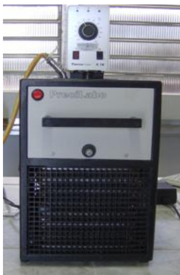
Figura E.1 Banho térmico utilizado para calibração dos sensores Pt-100.
