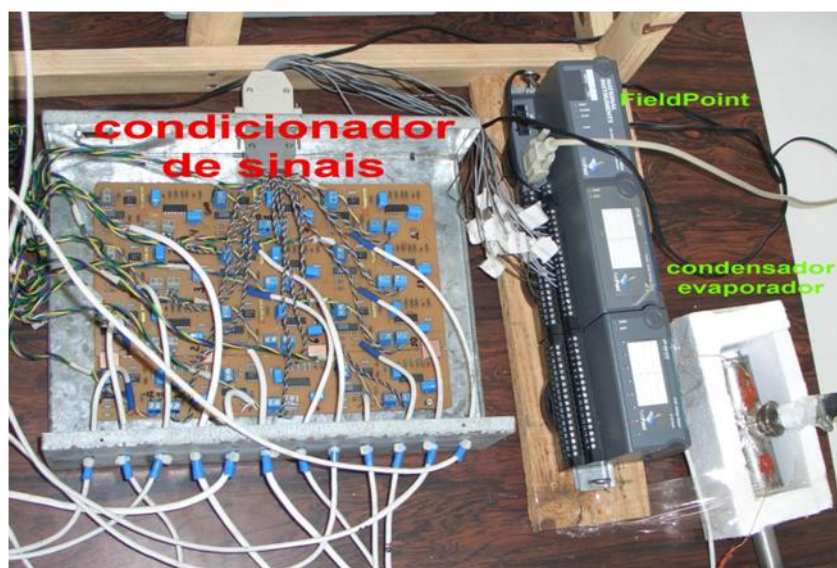
Figura 6.27 Vista parcial do aparato experimental com ênfase no sistema Fieldpoint, condicionador de sinais e condensador/evaporador.
