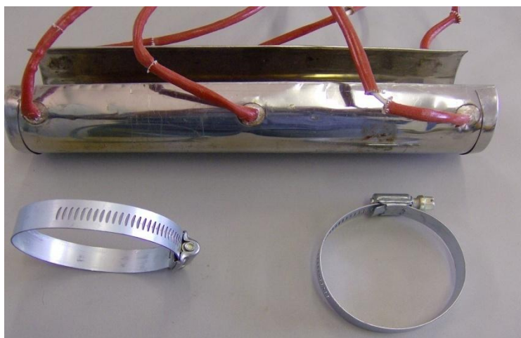
Figura 5.3 Aquecedor resistivo e abraçadeiras utilizadas para fixação ao dsorvedor.
