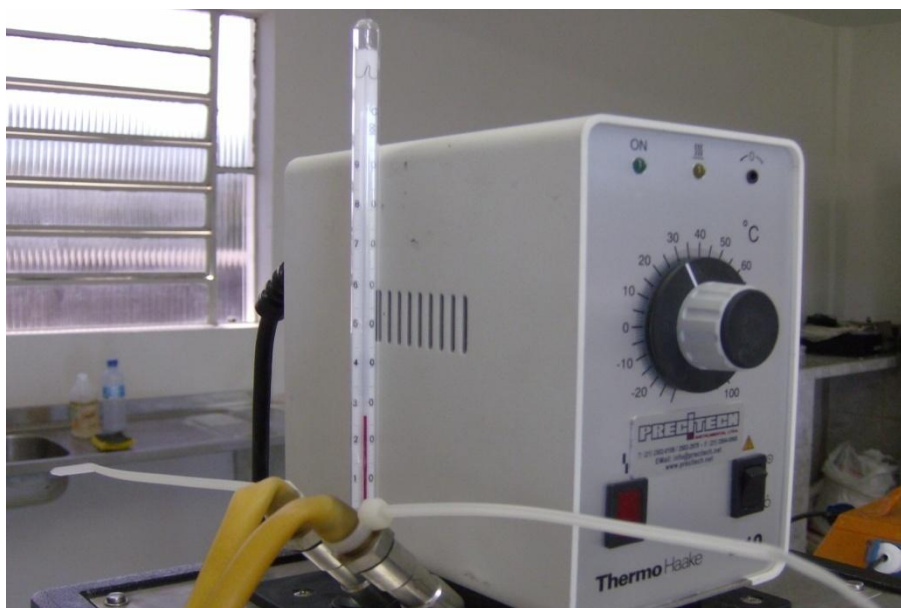
Figura E.2 O termômetro padrão de mercúrio incorporado ao banho térmico.
