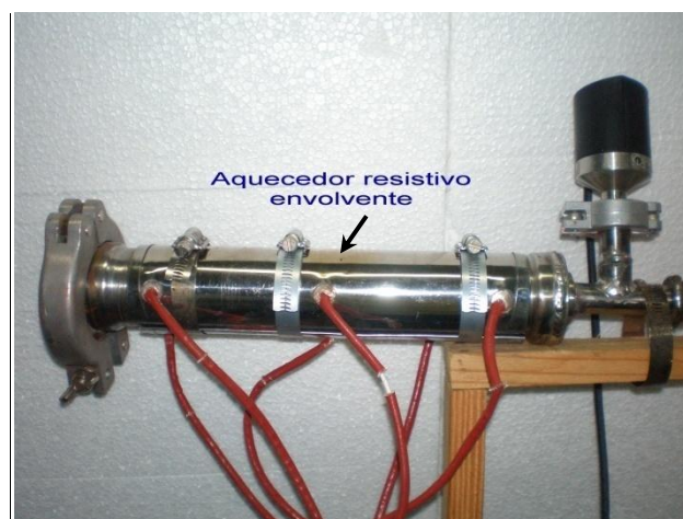
Figura 5.1 Adsorvedor envolto pelo aquecedor resistivo.
