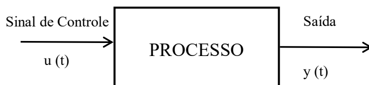
Figura F.4 Diagrama em blocos de um sistema de controle em malha aberta.
