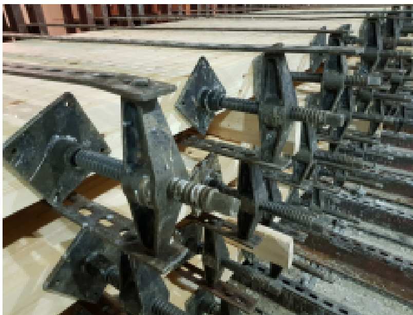
Figura 5 - Processo de colagem das lâminas de um elemento de MLC
