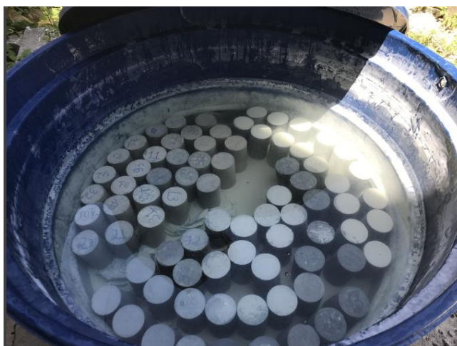
Figura 31 - Processo de cura úmida
