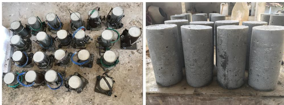
Figura 30 - Moldagem dos corpos de prova (a) e Desmoldagem dos corpos de prova (b)
