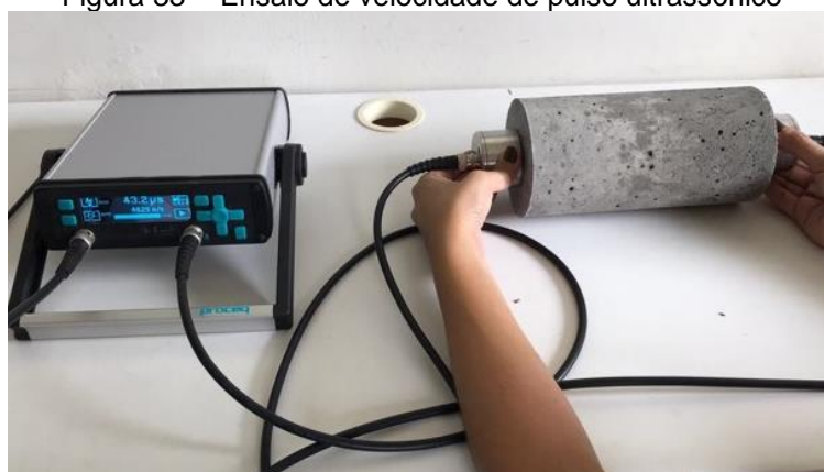
Figura 33 - Ensaio de velocidade de pulso ultrassônico
