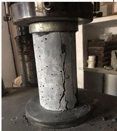
Figura 32 - Ensaio de resistência compressão
