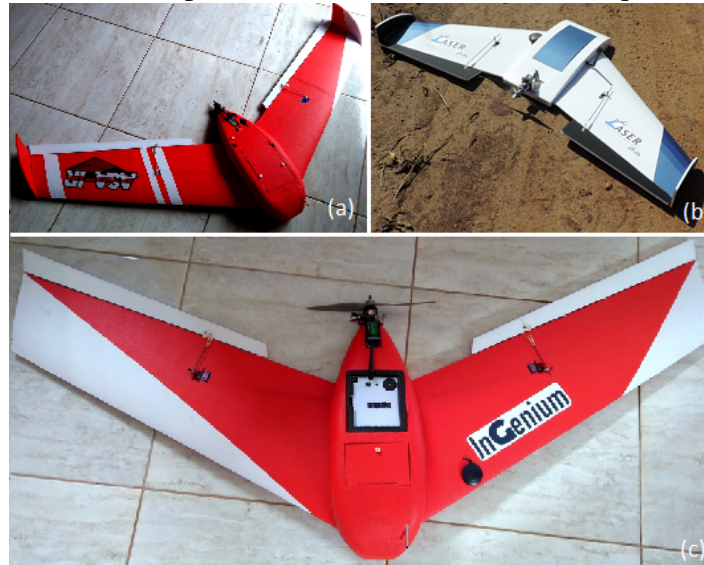
Figura 4.1: VANT para sobrevoos em áreas de até 150 ha (a), VANT para sobrevoos em áreas de até 150 ha (b) e VANT para sobrevoos em áreas maiores que 300 ha (c).
