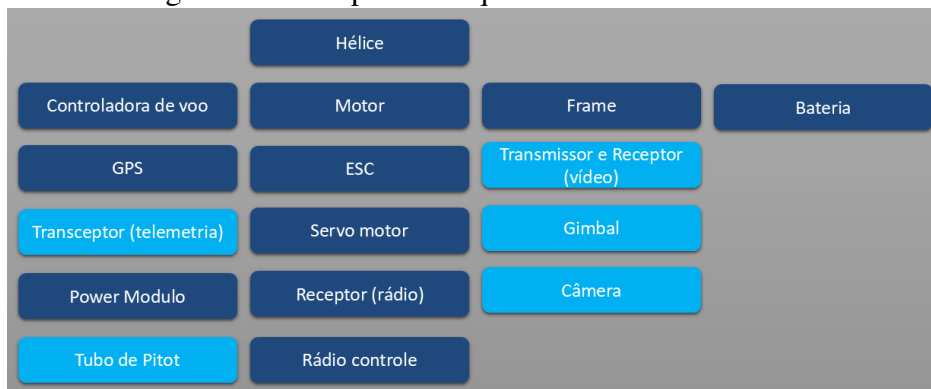
Figura 2.4: Componentes que constituem um VANT.
