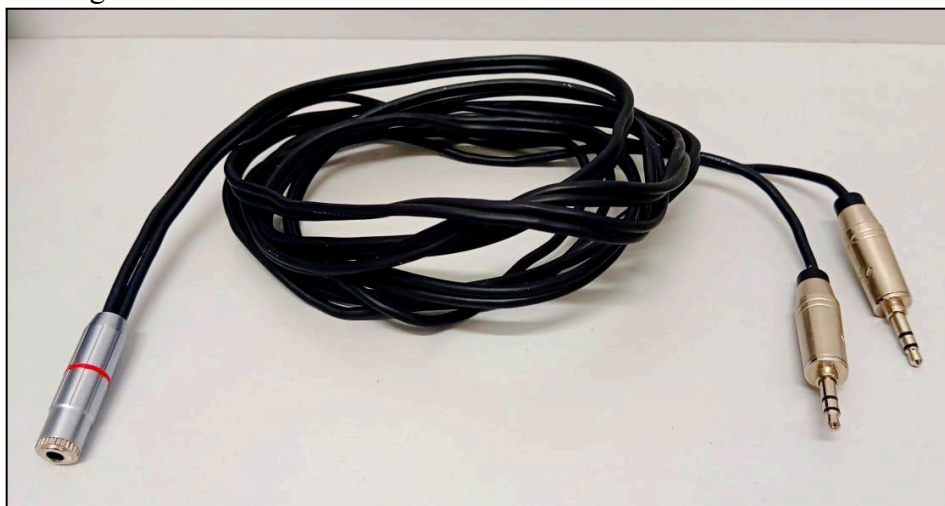
Figura 4.9 – Cabo confeccionado com duas entradas e uma saída.
