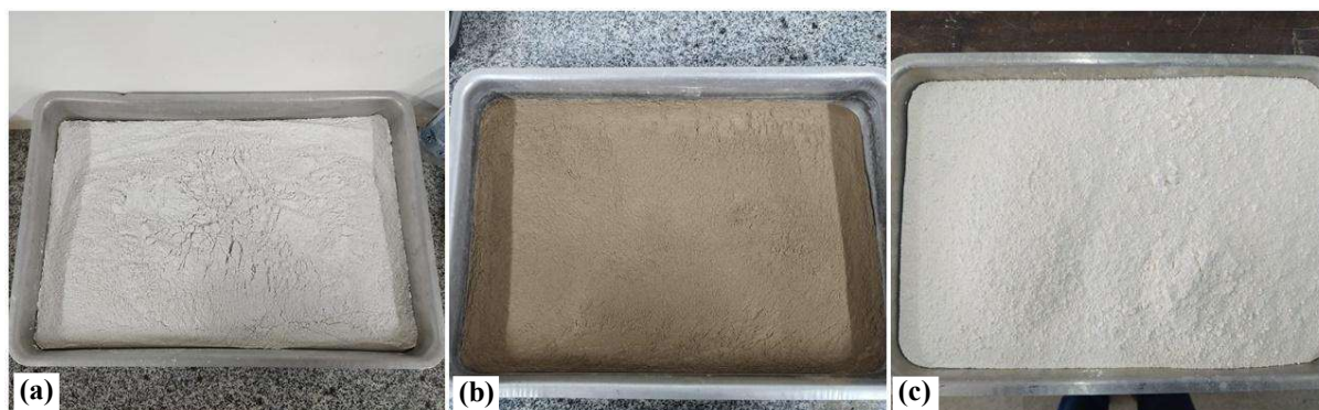
Figura 15 - Pós obtidos após o beneficiamento: (a) do resíduo do polimento do porcelanato; (b) da argila vermelha; (c) da argila branca
