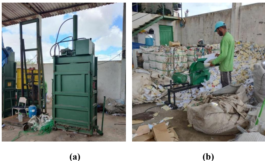
Figura 3.6 Prensa hidráulica vertical (a) e triturador forrageiro (b) usados no processamento de resíduos da cooperativa Itamare.
