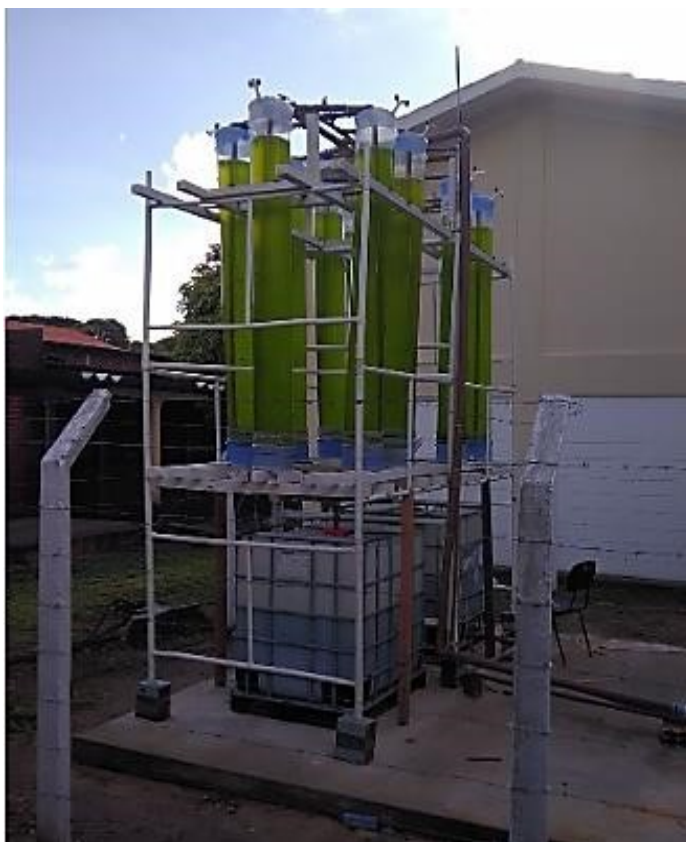
Figura 4 - Fotobiorreator construído pelos alunos do Laboratório de Ambientes Recifais e Biotecnologia com Microalgas - LARBIM/UFPB
