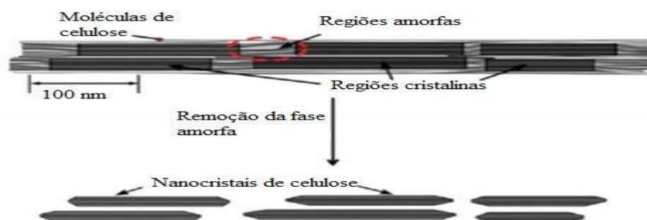
Figura 5: Nanocristais de celulose unidos, constituindo as nanofibrilas. Fonte: SILVA et al., (2009), adaptada.
