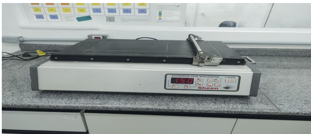
Figura 18: Mesa laminadora da marca SHEEN utilizada no revestimento do papel.
