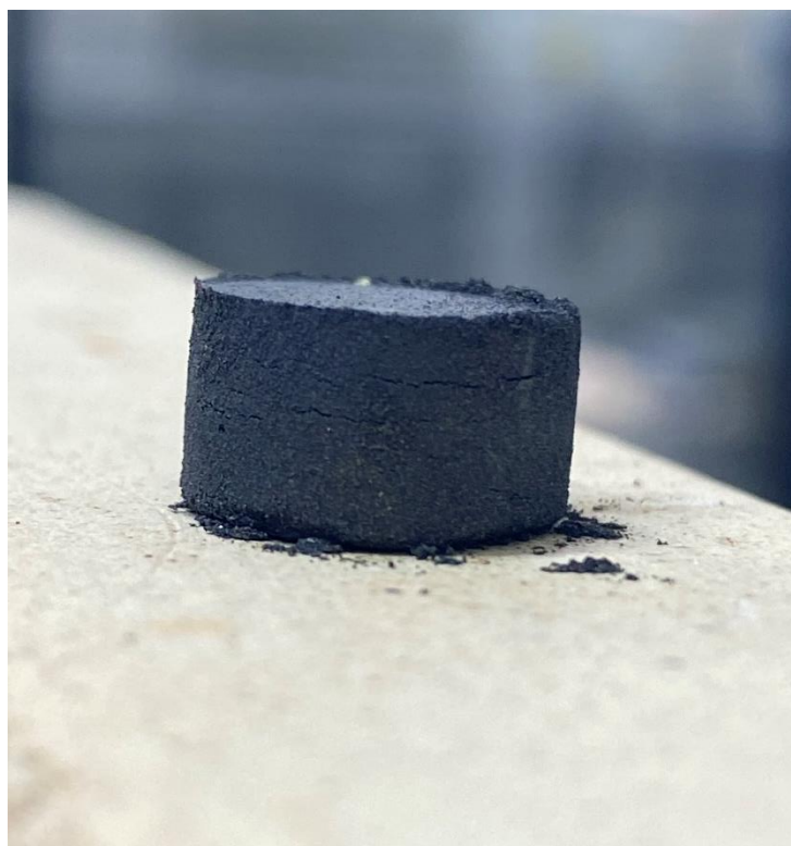
Figura 5. Amostra de (\text{Cu}_{50}\text{Mn}_{25}\text{Sn}_{20}\text{Al}_5)_{1-x}(\text{ZnO})_x após sinterização. Fonte: Autor (2025).
