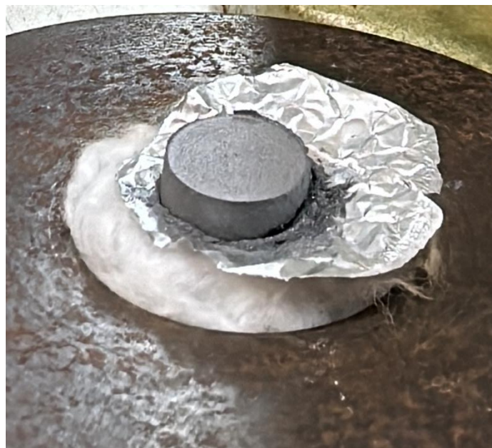
Figura 3. Amostra a verde após compactação dos pós. Fonte: Autor (2025).
