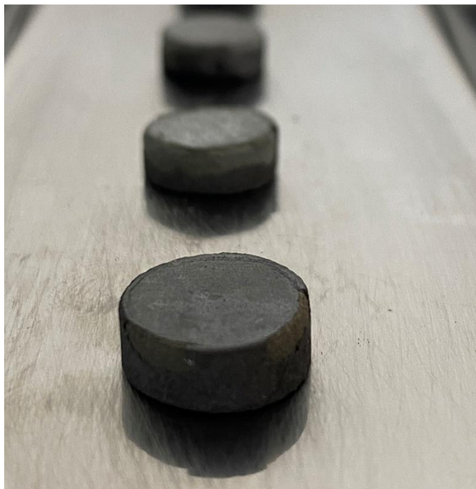
Figura 4. Amostras de (\text{Cu}_{50}\text{Mn}_{25}\text{Sn}_{20}\text{Al}_5)_{1-x}(\text{ZnO})_x após sinterização. Fonte: Autor (2025).
