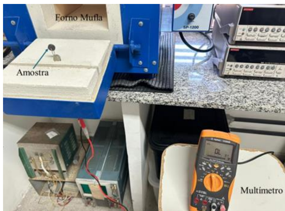
Figura 6. Montagem experimental para os ensaios termoeletricos. Fonte: Autor (2025).
