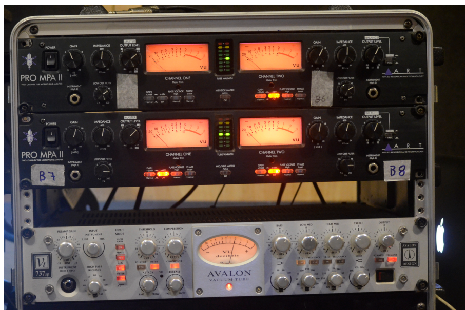
Figura 10: Pré amplificadores Pro MPAlI e Avalon sp737. Arquivo pessoal.
