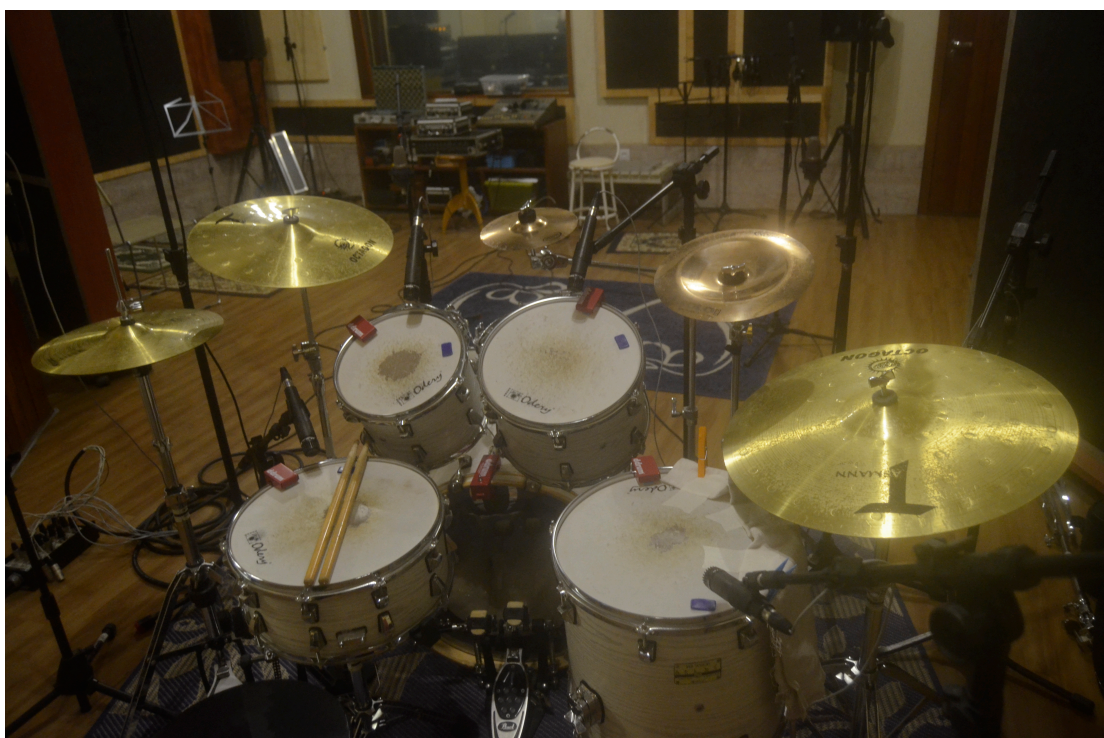
Figura 21: Triggers aplicados na bateria.
