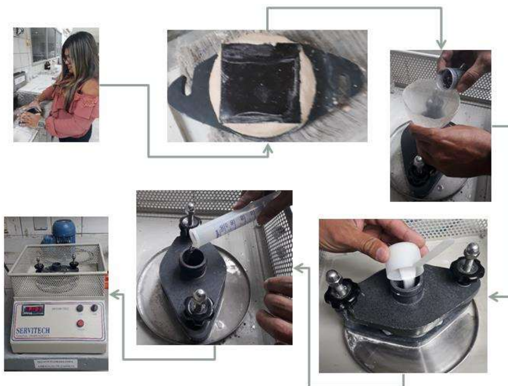
Figura 3.13. Ensaio de abrasão conforme ABNT NBR 13818:1997.
