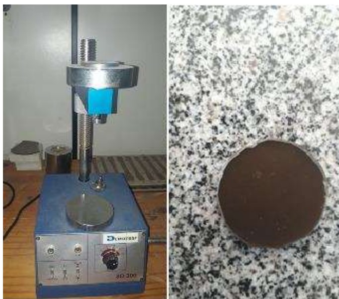
Figura 3.11. Ensaio de dureza, tipo Shore D, conforme norma supracitada. Equipamento usado para o ensaio (esq.) e corpo de prova submetido ao ensaio (dir.).
