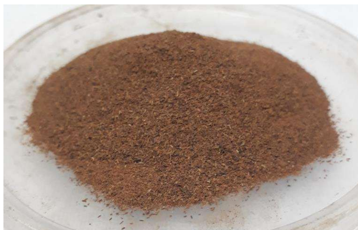
Figura 3.2. Fibra de piaçava moída em moinho de facas e moinho de bolas, respectivamente.
