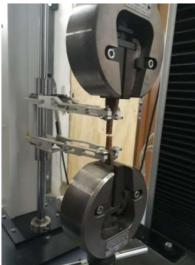
Figura 3.8. Ensaio de tração conforme a ASTM D638
