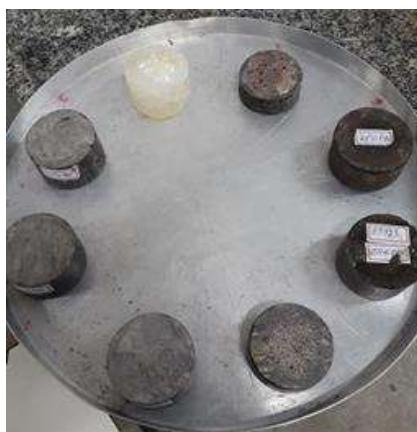
Figura 3.6. Corpos de prova para ensaio de absorção de água conforme ASTM D570-18.
