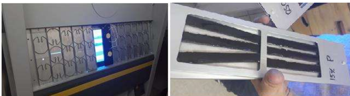
Figura 3.12. Ensaio de envelhecimento por raios ultravioletas aplicados em câmara de atmosfera controlada (esq.) e amostras posicionadas para submissão ao ensaio (dir.).
