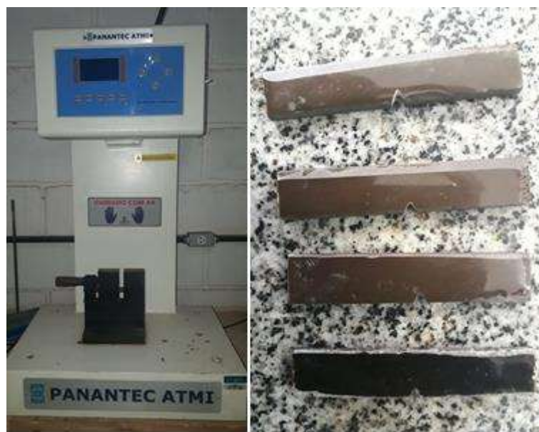
Figura 3.10. Ensaio de impacto Izod conforme norma ASTM D256. Equipamento usado para o ensaio (esq.) e os corpos de prova submetidos ao ensaio (dir.).
