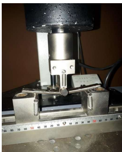
Figura 3.7. Ensaio de flexão conforme a ASTM D790.
