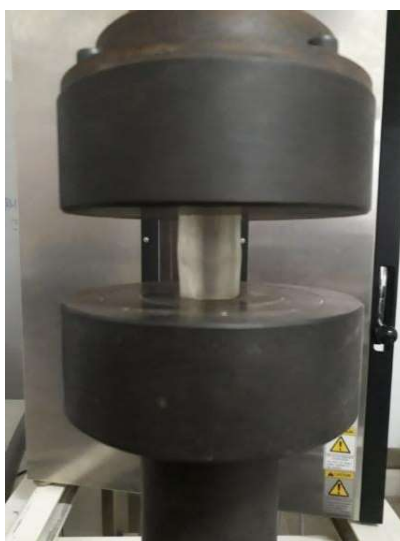
Figura 3.9. Ensaio de compressão conforme ASTM D695.
