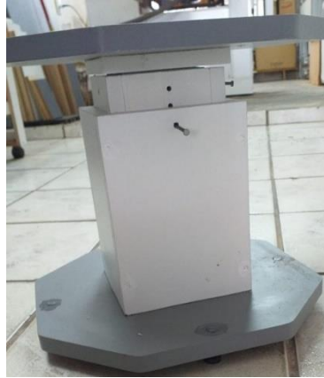
Figura 2 – Banco para padronização da amplitude do agachamento
