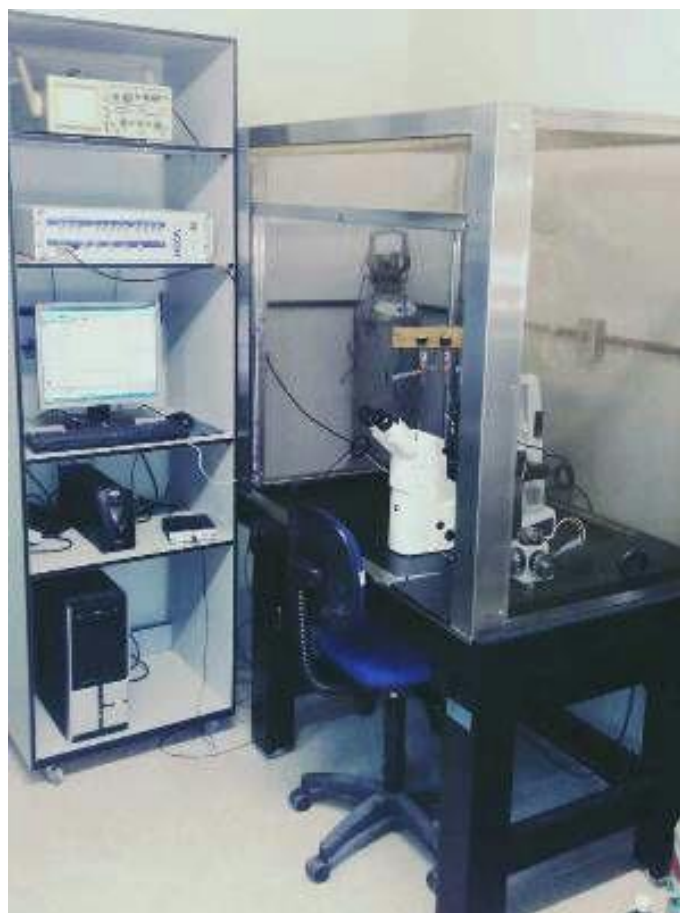
Figura 7: Setup de eletrofisiologia celular – Patch Clamp do laboratório de biotecnologia celular e molecular (LBCM).
