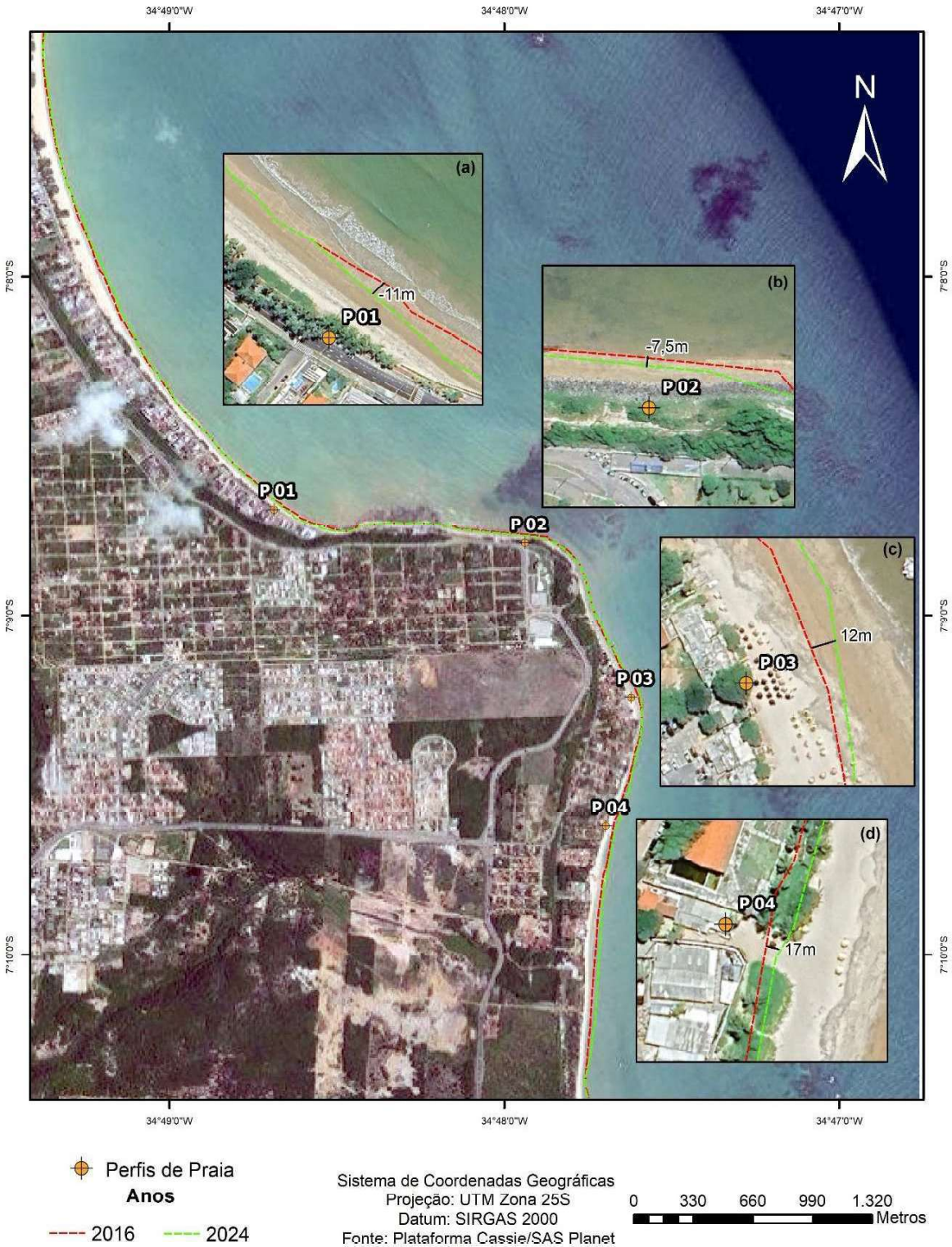
Figura 39. Comparação entre a localização dos perfis topográficos e a variabilidade da linha de costa para os anos de 2016 e 2024.
