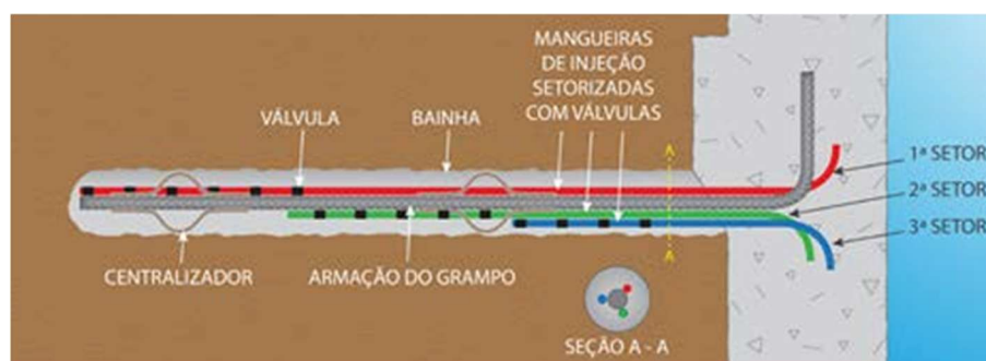
Figura 12: Partes constituintes de um grampo (chumbador)
