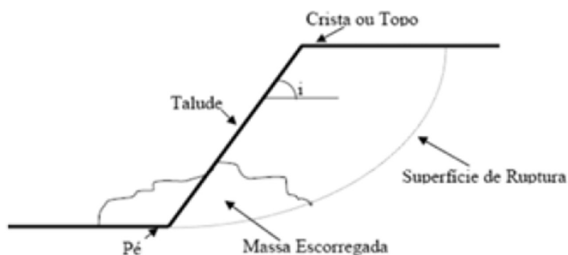
Figura 2: Componentes de um talude
