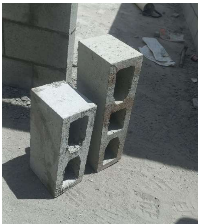
Figura 3: Bloco de concreto
