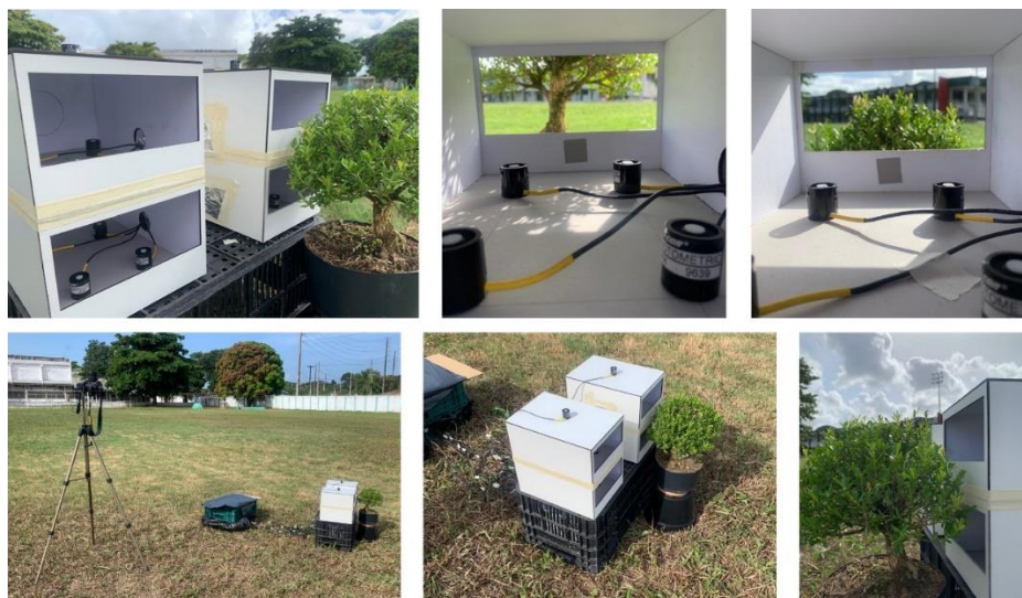
Figura 21 – Imagens da disposição dos modelos no momento das medições da iluminância
