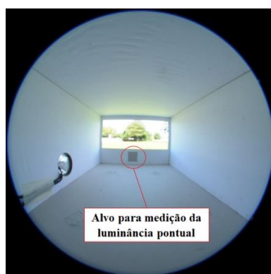
Figura 26 – Cena com destaque para o alvo de medição da luminância pontual (cartão cinza)
