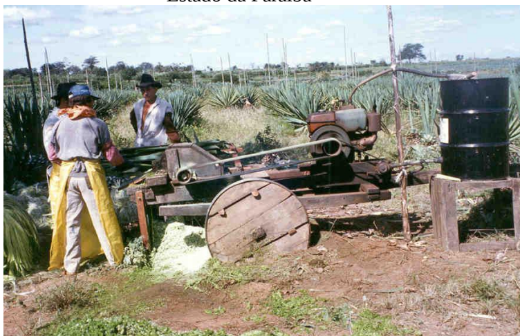
Fotografia 11 – Máquina Paraibana desfibrando folhas de sisal em regiões produtoras do Estado da Paraíba
