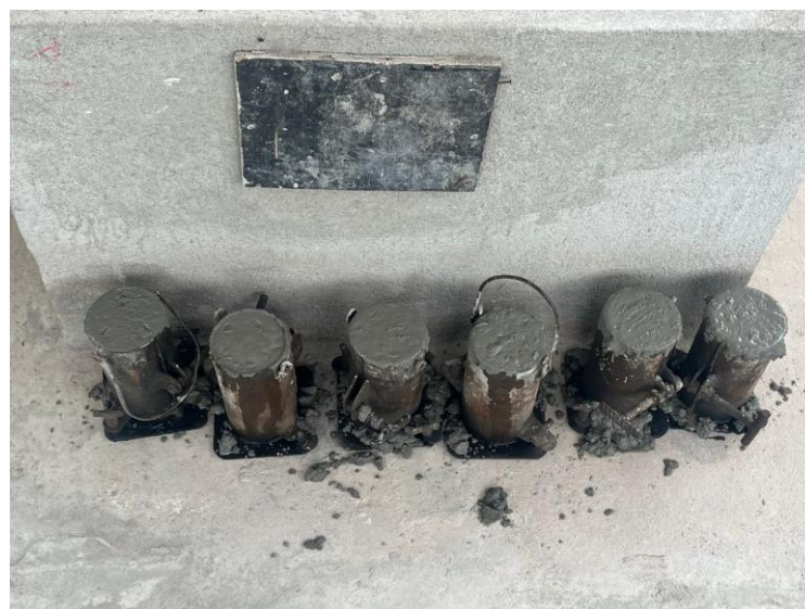
Figura 46 – Corpos de Prova do Concreto
