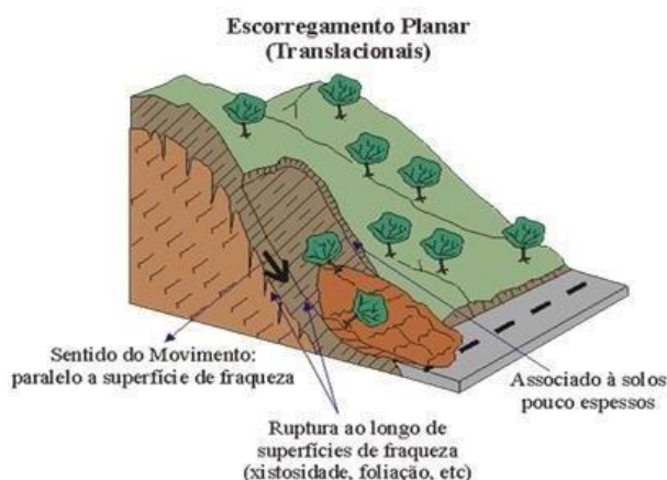
Figura 3 - Ocorrência de escorregamentos planares ou translacionais
