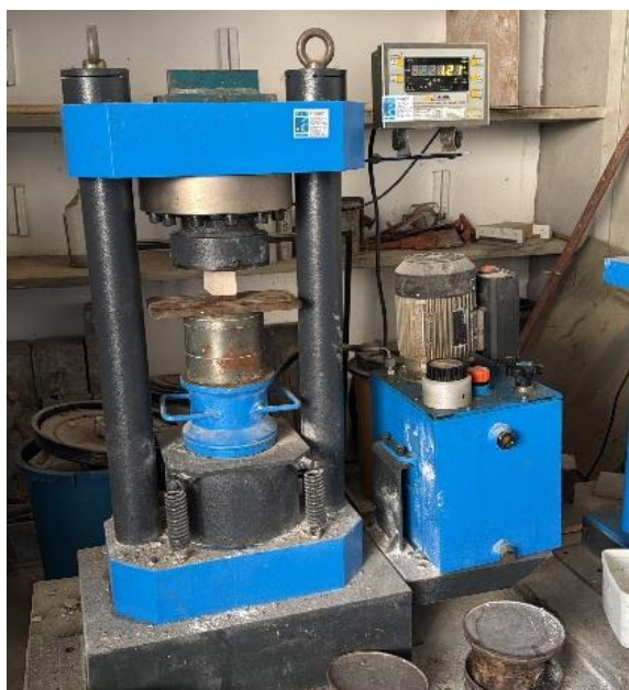
Figura 13: Ensaio de resistência à compressão
