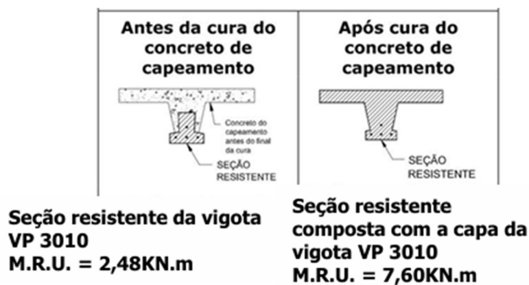
Figura 29: Resistência das vigotas antes e depois da cura do concreto de capeamento.
