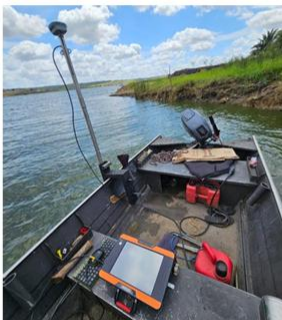
Figura 6 - Equipamentos utilizados no levantamento batimétrico.
