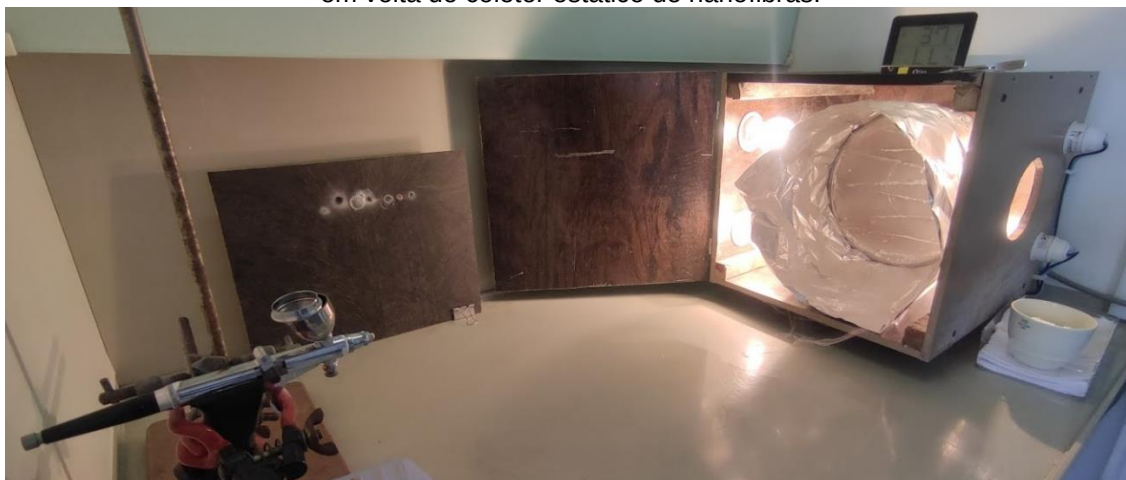
Figura III.2- Arranjo do espaço para produção de nanofibras por SBS, incluindo a câmara aquecida em volta do coletor estático de nanofibras.
