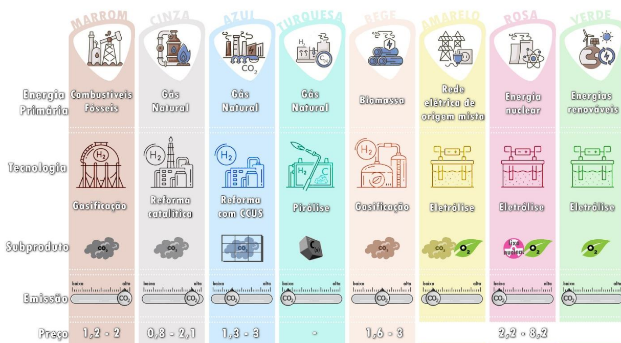
Figura 3.4 - Classificação em escala cromática do hidrogênio produzido de acordo com a energia primária utilizada e da tecnologia adotada para sua produção.
