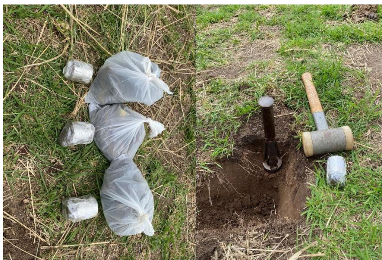
Figura 10 – Amostras indeformadas coletadas em pontos específicos de cada parcela experimental
