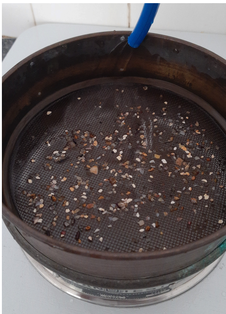
Figura 5: Peneiramento úmido. Fonte: Autoria própria, 2025.
