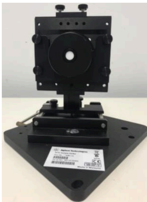
Figura 8: Suporte de sólidos do espectrofluorímetro. Fonte: Autoria própria, 2025.
