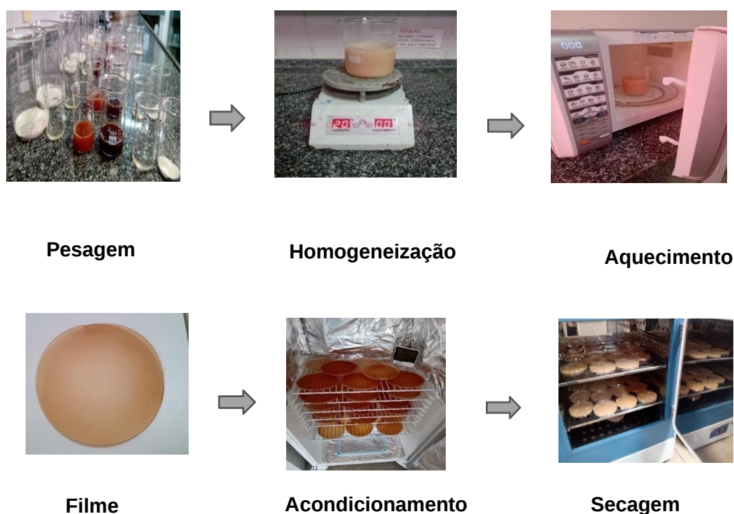
Figura 2: Fluxograma da produção dos filmes biodegradáveis.
