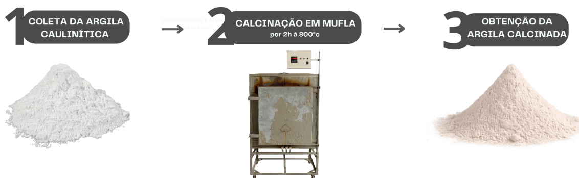
Figura 11 - Fluxograma de processos para obtenção da argila calcinada
