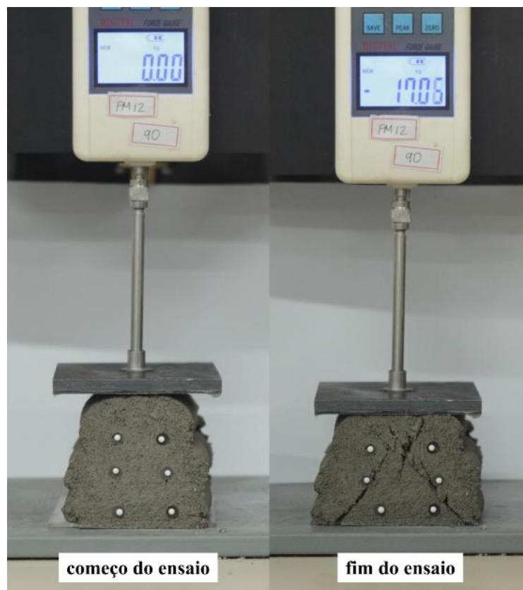
Figura 8 – Teste de resistência à compressão verde
