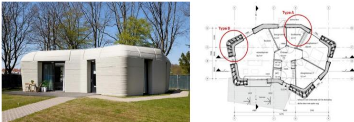
Figura 2 – A primeira casa impressa em 3D do Projeto Milestone (Foto de Bart van Overbeeke) e sua planta baixa
