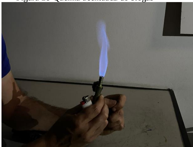
Figura 28-Queima acentuada do biogás
