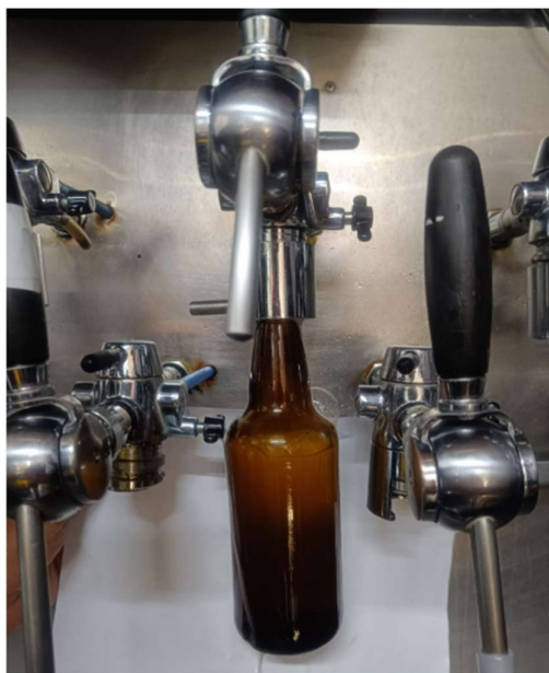
Figura 3 – Processo de envase por contrapressão da cerveja
